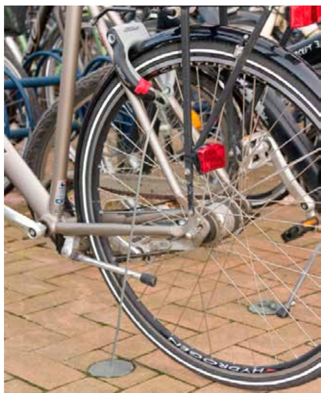
Figur 8. Eksempel på wirelåse ved cykelparkering, som hjælper imod tyveri af cyklen.
