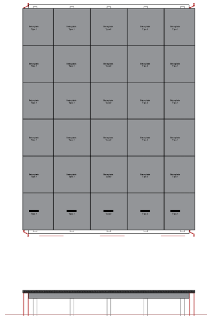
Figur 6 - Efter gentagende fase 1-4 (overside fald på elementer er ikke vist)
