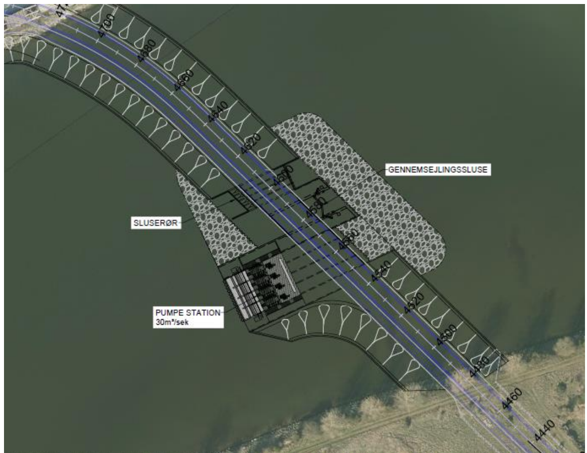
Figur 5-6 Højvandsporte og pumpeanlæg ved udløbet af Bygholm Å, figuren findes også i bilag 10.
