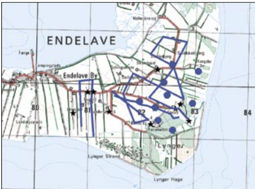
Figur 10: De blå linjer viser de geofysiske undersøgelser. De blå prikker er de borer, der er pejet og prøvepumpet.
